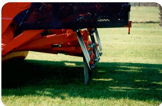
Le décompacteur Verti-Drain permet d'obtenir une aération du sol en profondeur.
